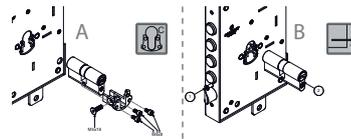
11) Non forzare l'inserimento del cilindro durante il montaggio.
